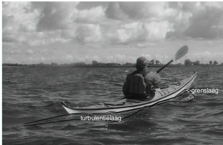
Fig. 6. De dunne grenslaag en de brede turbulentielaag langs de kano
